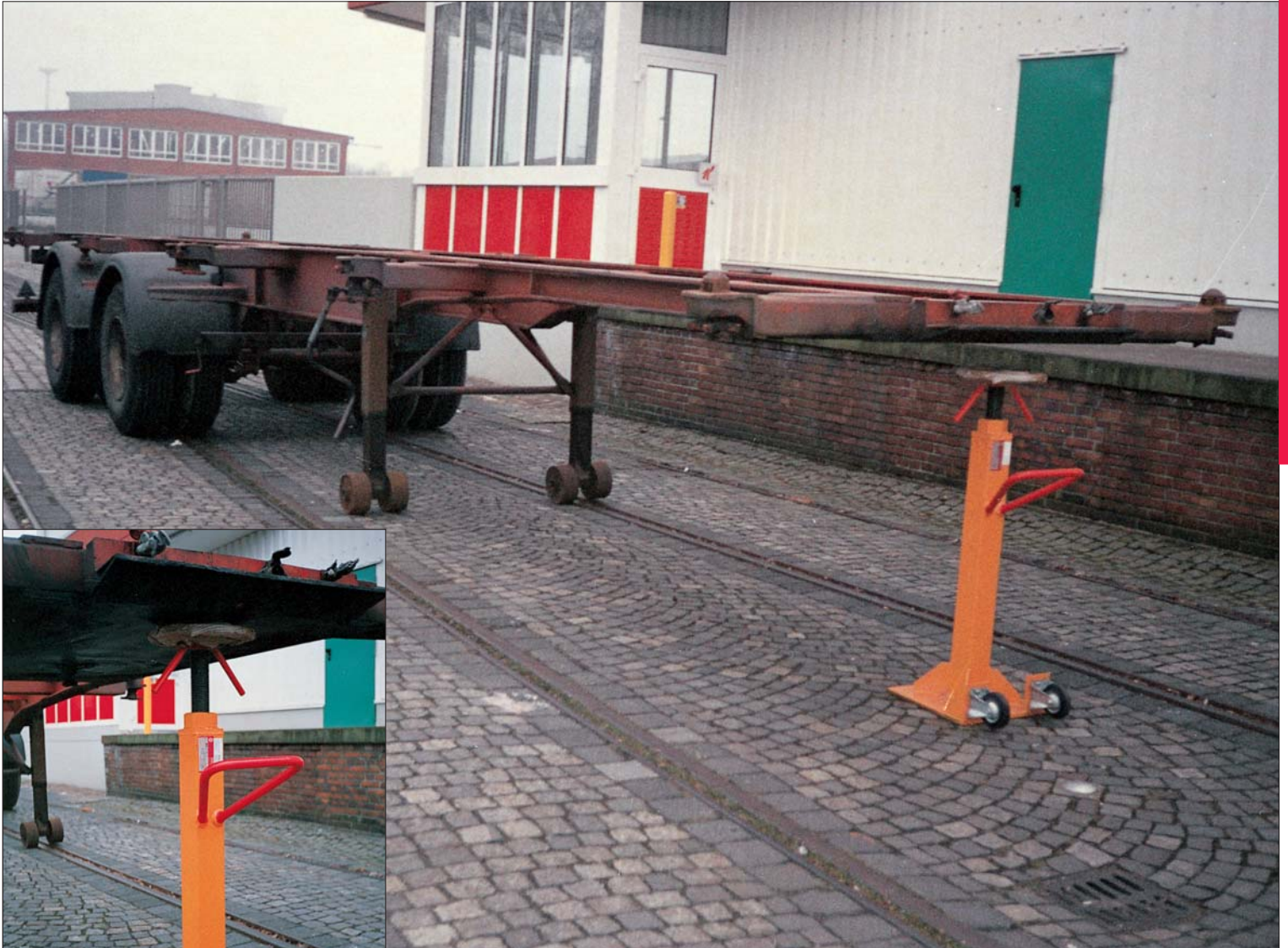
◀ safety-jack 1. Drehteller-Auflager manuell höhenverstellbar. Wird mittig untergestellt.
