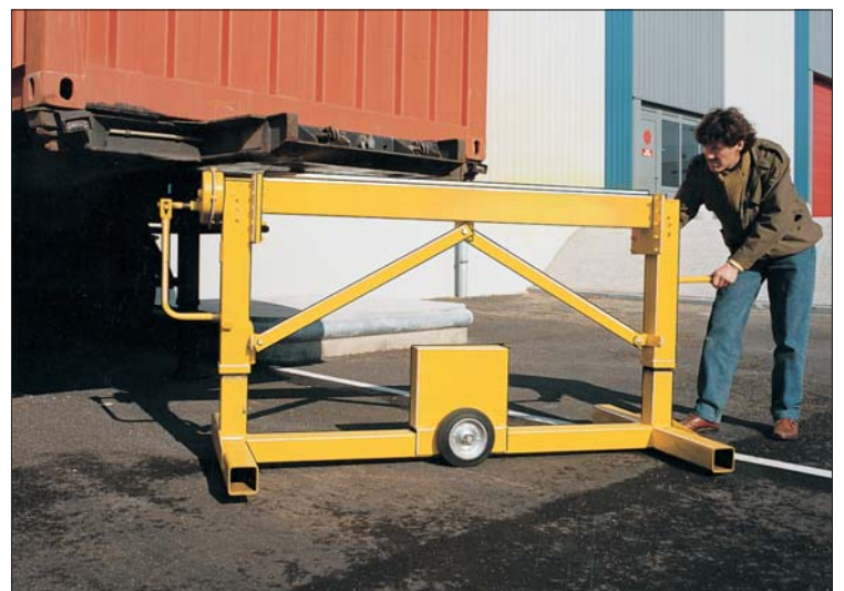
▼ safety-jack 2. Gesamte Auflagerbreite wird mittels Handkurbel höhenverstellt.
