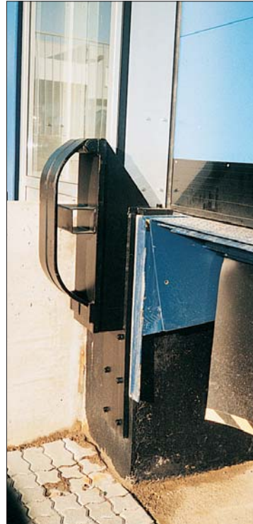
Freistehende Säulenpufferung ▲ mit Dual-Federstahlpuffer. Säule steckbar in Halterung alternativ fest montiert. Höhe 1 600 mm, Ges.Br. 250 mm
