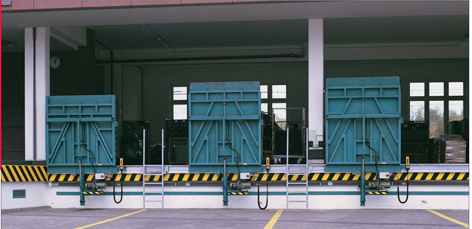
Verladeanlage mit integrierten verschiebbaren Rampenleitern
