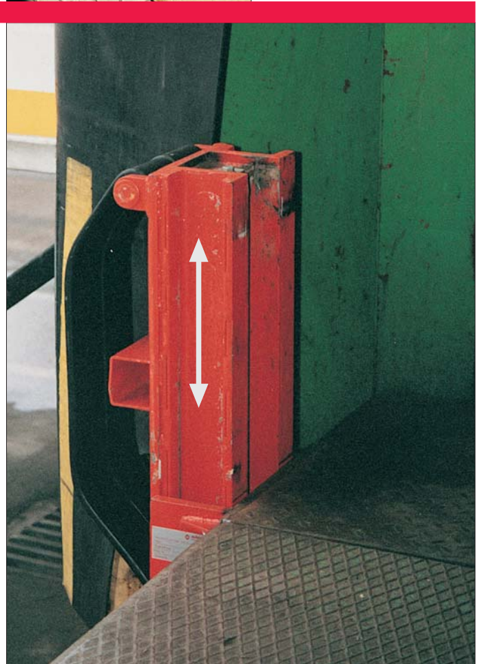
Freistehende Säulenpufferung ▲ mit Dual-Federstahlpuffer. Säule steckbar in Halterung alternativ fest montiert. Höhe 1 600 mm, Ges.Br. 250 mm
