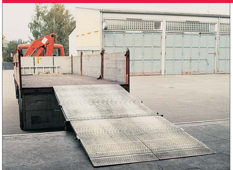
federmechanische Verladebrücke aus Aluminium, verschiebbar ◀
