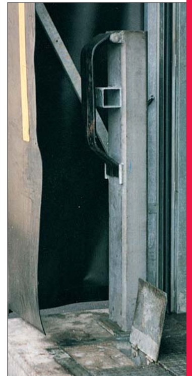
Freistehende Säulenpufferung ▲ mit Dual-Federstahlpuffer. Säule steckbar in Halterung alternativ fest montiert. Höhe 1 600 mm, Ges.Br. 250 mm
